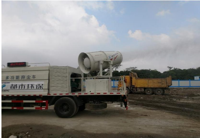
图 6.6 多功能抑尘车洒水降尘
